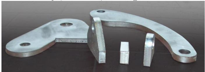
Dopo il taglio, gli oggetti vengono puliti in maniera meccanica per eliminare macchie e sbavature dovute al taglio laser. Cionostante possono essere presenti alcune "bave" in punti difficili da raggiungere, di dimensioni non superiori a 1mm, dovute ad una leggera fusione del materiale. Le parti vicine al taglio possono cambiare colorazione. Il tutto può essere rimosso e pulito con pasta abrasiva specifica per l'acciaio (anche i detergenti comunemente usati in casa), solventi o carta vetrata.
